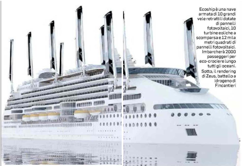
Ecoship è una nave armata di 10 grandi vele retrattili dotate di pannelli fotovoltaici, 10 turbine eoliche a scomparsa e 12 mila metri quadrati di pannelli fotovoltaici. Imbarcherà 2000 passeggeri per eco-crociera lungo tutti gli oceani. Sotto, il rendering di Zeus, battello a idrogeno di Fincantieri
